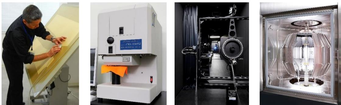
ニッセンケンの保有する各種試験設備。左から CAD(素材の面積測定)、45/0°方式蛍光測色計、15m 暗室と再帰性反射性能測定機、キセノン耐光試験機、カーボンアーク耐光、その他規定されている試験にも対応いたします。
