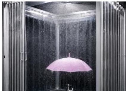
⑰漏水性試験
