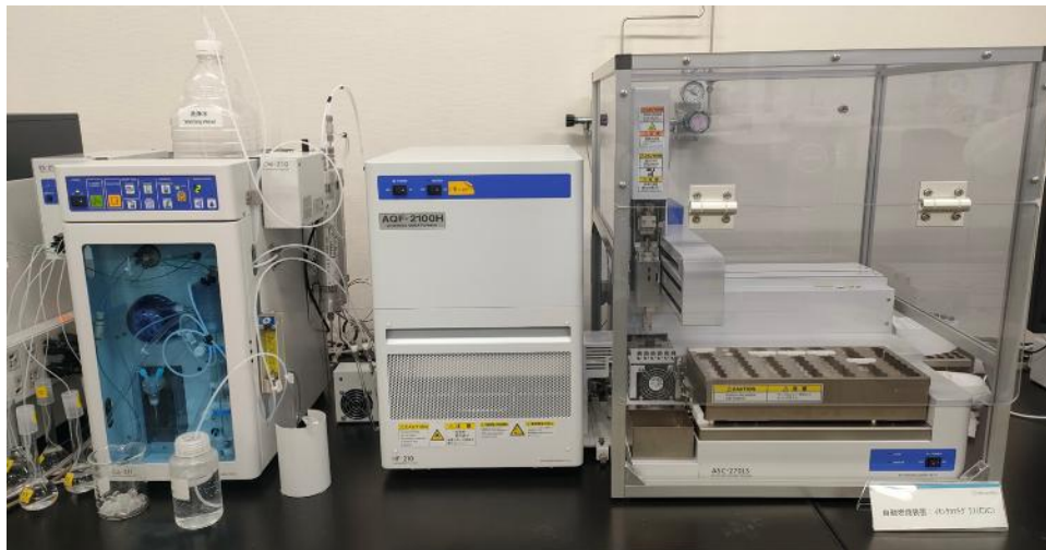
図2 燃焼イオンクロマトグラフィー（CIC）
