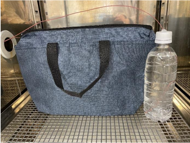
▲槽内での試験の様子 (ペットボトル 2 本のうち 1 本を保冷バッグに収納し、それぞれに温度センサーを取り付けて温度変化を測定)
