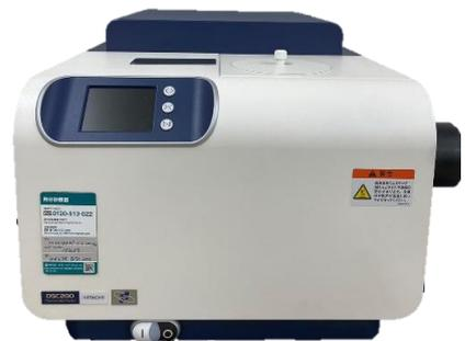
図2 DSC（示差走査熱量計）
