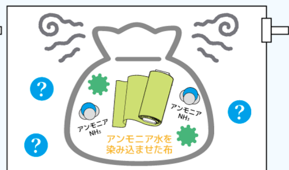
ポリ袋から漏れたアンモニアの濃度を測定
