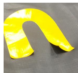
図1 顔料プリントのはく離の例 (生地はポリエステル織物 はっ水加工あり)
