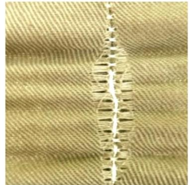
図7 滑脱(スリップ)事故の一例
